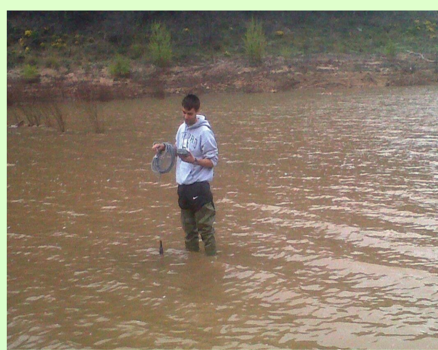
Figura 5: Análisis in situ con sonda multiparamétrica (cola de El Atance)
